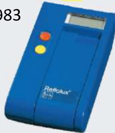
Digitales BZ-Messgerät Reflolux (Boehringer Mannheim), 1983, ca. 270 g schwer.
