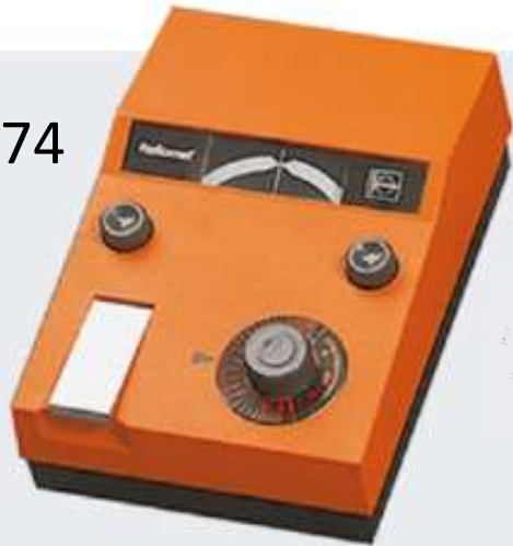
Reflomat (Boehringer Mannheim), analoges BZ-Messgerät von 1974. 1,1 kg schwer.
